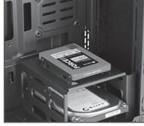
İlk olarak, istenilen aygıtı resimde gösterildiği gibi bölmenin üst tarafına yerleştirin.
