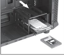
Depolama aygıtının kurulumu için, bölmenin içine 2,5 inçlik sürücünün takılacağı yer.
